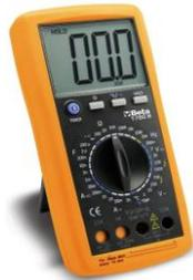
(SPÉCIFICATIONS Tension CC : 200 mV-2/20/200/1000V. Tension CA :: 2-20/200/700V Courant CC : 2/20/200 mA-20 A. Courant CA : 2/200 mA- 20 A. Résistance : 200Ω - 2/20/200 kΩ - 2/20 MΩ Capacité : 2/20/200 nF - 2/200 μF. Température : -20° + 1000°C/ - 4 °F ~ +2000°F Fréquence : 20kHz)
